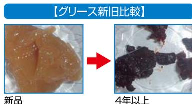
グリースの劣化は摺動不良や各部の摩耗を引き起こし、ギャップの自動調整機能やウェッジ機構のスムーズな作動を防げます。場合によっては、制動力不足やブレーキの片効き、引き摺りを発生させる恐れがあります。引き摺りは、ブレーキドラムを過熱させ車両火災に至ることもあります。
